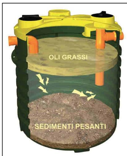
La degrassatura è un **pretrattamento fisico di rimozione** degli oli, delle schiume, dei grassi, e di tutte le sostanze che hanno peso specifico inferiore a quello del liquame, provenienti da lavandini, docce, bidet, lavatrici e lavastoviglie.
