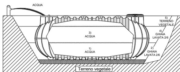
**2.2** Dopo aver riempito e rinfiancato in modo adeguato il serbatoio, ricoprire gradualmente con del **terreno vegetale (NON di natura argillosa/limosa, NON materiale di scavo)** per 30/40cm, lasciando liberi i tappi di ispezione. In questo modo l'area interessata è **pedonabile** ed è **vietato** il transito di automezzi fino a 2m di distanza dallo scavo. **N.B. Per rendere il sito carrabile leggere il cap. 4 "Carrabilità".**
